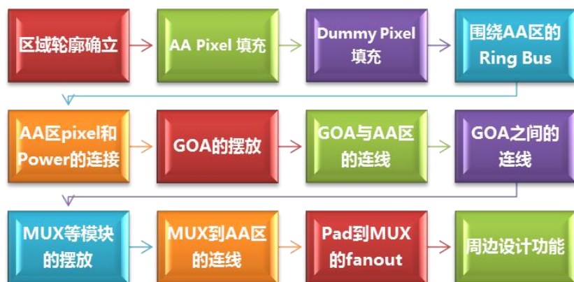
图示1 Empyrean Aether®FPD LEXP异形版图设计Flow
